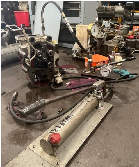
รูปที่ ๑๓ เครื่องมือตรวจสอบน้ำมันเชื้อเพลิงเข้าห้องเผาไหม้
