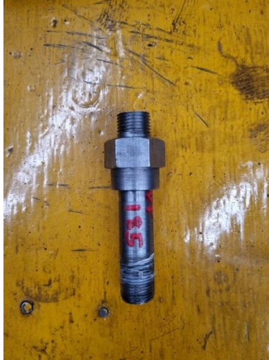
รูปที่ ๑๑ เครื่องมือต่ออุปกรณ์อัดน้ำยาเข้ากับฝาสูบ
